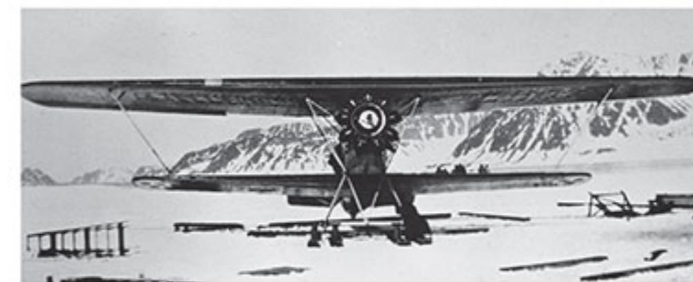
Voor landingen op sneeuw konden de toestellen voorzien worden van dubbel uitgevoerde ski's.
